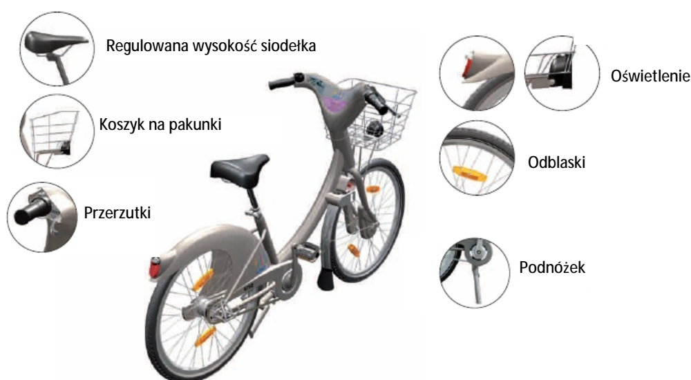
Rys. 2.9 Schemat roweru działającego w systemie „Velib” w Paryżu. Źródło: na podstawie „Velib”
