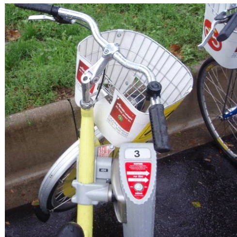
Fot. 18 Wiedeń – rower w systemie CityBike – widok automatycznego zapięcia roweru do stacji dokującej. Źródło: TransEko
