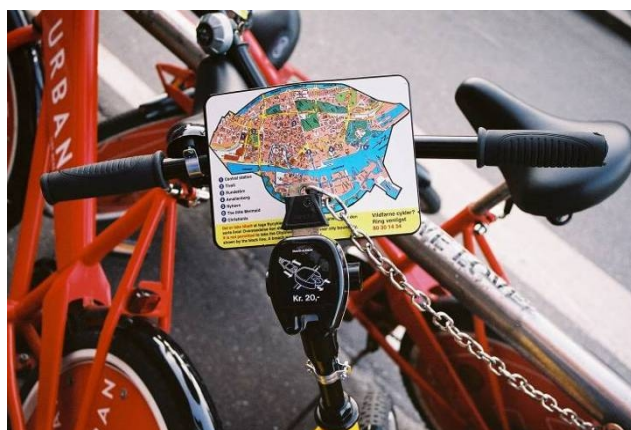
Fot. 14 Kopenhaga – widok na zapięcie roweru umożliwiające (po włożeniu monety) odblokowanie łańcucha przypinającego. Źródło: TransEko
